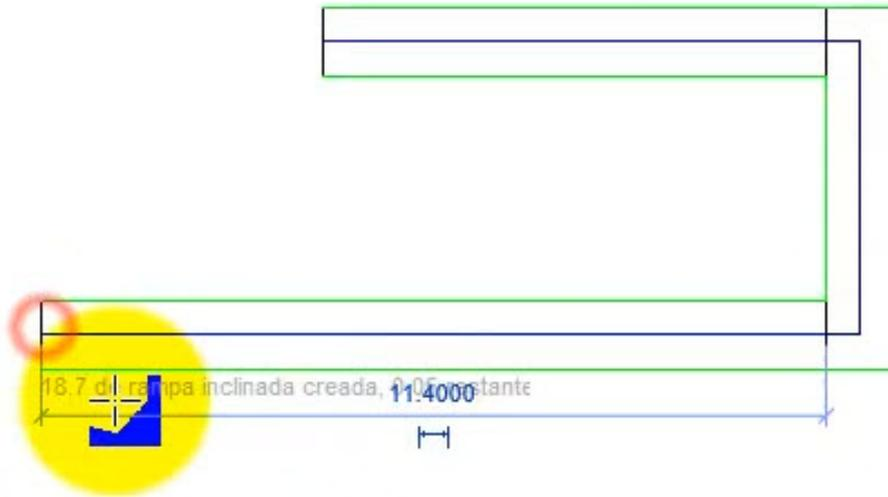
Para realizar una rampa con diferentes pendientes, en primer lugar creamos los tipos que necesitamos, por ejemplo una rampa para párquing al 4% - 16% - 4%. Empezamos por el primer tramo y para ello
