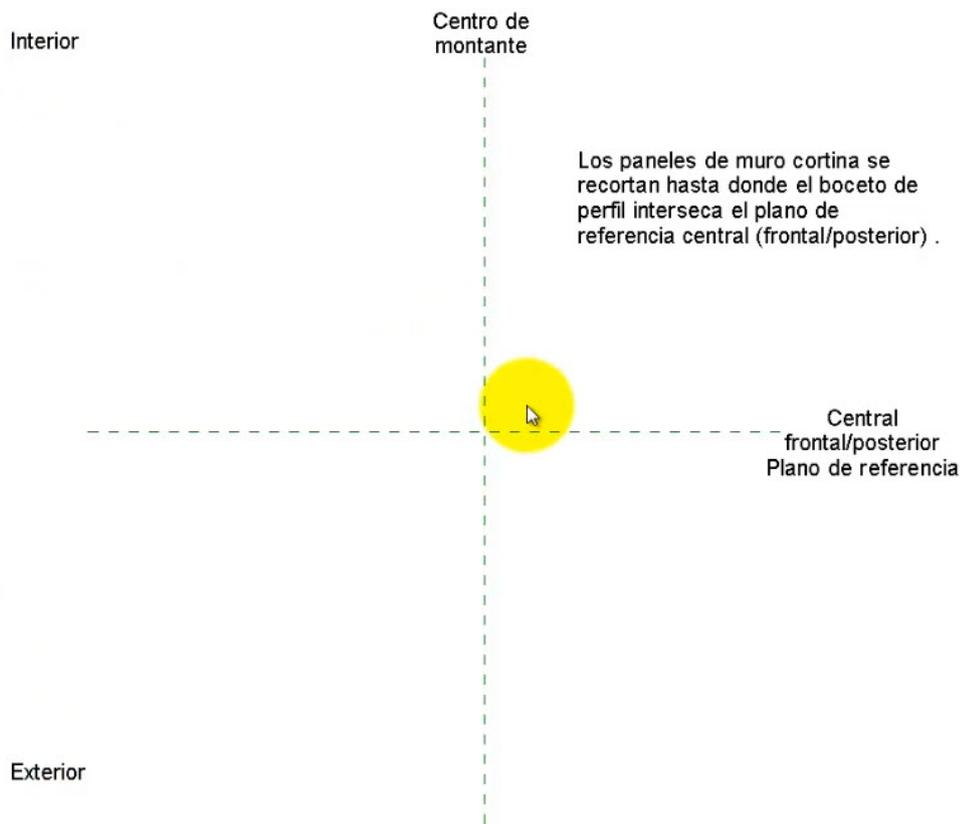
Observamos que nos aparece dónde estará el exterior e interior del muro que va a contener este montante o perfil que vamos a hacer. También nos aparecen dos planos, el central frontal/posterior del montante y el del centro del montante. Éstos nos van a dar el corte con los paneles del muro cortina, es decir, donde yo dibuje mi montante, cuando intersecten con la forma que hayamos dibujado, el panel parará.
